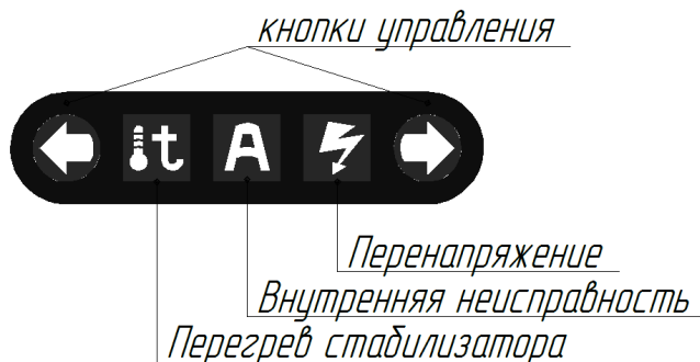
Рисунок 3. Кнопки управления и пиктограммы неисправностей.
