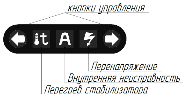
Рисунок 3. Кнопки управления и пиктограммы неисправностей.
