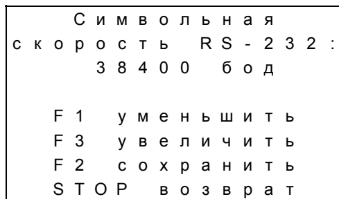
Рис.49. Символьная скорость интерфейса RS-232
