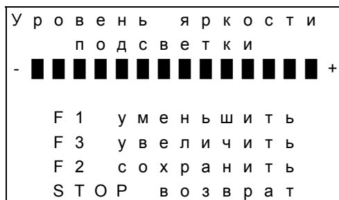
Рис.47. Яркость подсветки ЖК индикатора
